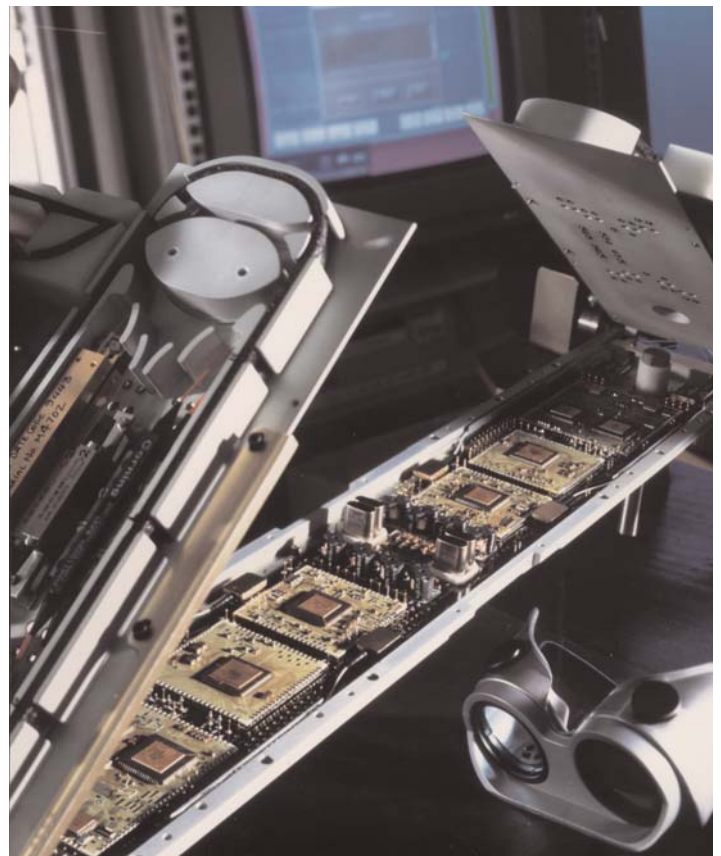
L'intérieur d'un répéteur sous marin d'un câble à fibres optiques (Alcatel)
