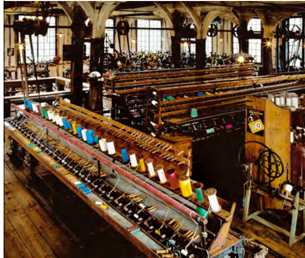
La corderie Vellois trouve son origine dans un moulin à coton installé en 1822 sur la rivière la Cailly, à Notre-Dame de Bondouville. Durant son activité, la corderie fut équipée de machines françaises et anglaises entraînées par l'énergie hydraulique. Indépendamment des assemblages et de la moulinerie Rye-Catteau, la corderie conserve également dans son atelier des cordes tressées plusieurs batteries de tresseuses construites à la fin du 19 e siècle par Marie Iréne, à Saint-Chamond, et au début du 20 e siècle par Tardy, à Sion. Les courroies et arbores de transmission d'entraînement Énergie aux machines transportent l'atelier. Denis Courchaie © Inventaire général, Région Haute-Normandie, 1994.
