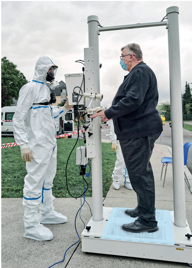
Portique portatif de contrôle de la contamination radiologique (2P2CR).
