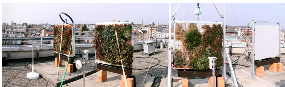
FIGURE 4.22 – Photographie panoramique du dispositif expérimental sur le toit de l'Hépià, de gauche à droite : bardage acoustique, brique modifiée, céramique, mur témoin
