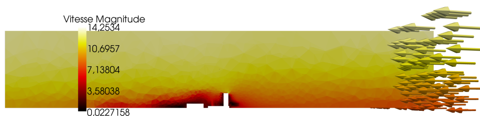
FIGURE 2.8 – Simulation de la vitesse du vent : coupe verticale dans une veine numérique
