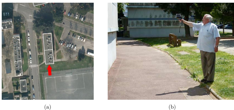
FIGURE 3.13 – Mesure de la température de surface en façade : (a) façade étudiée – (b) mesure au thermoradiomètre ©IRSTV
